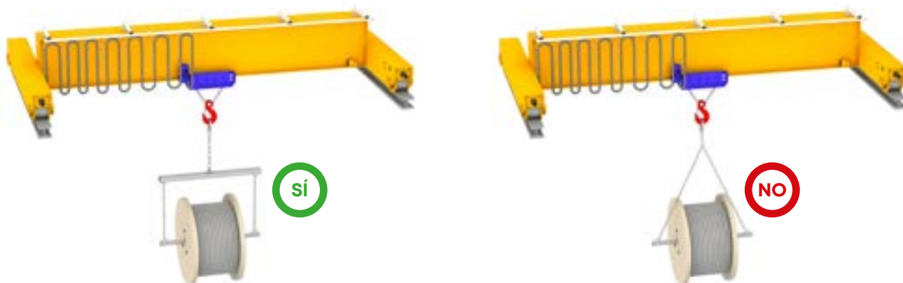
Figura 11. Posición correcta de las cadenas
