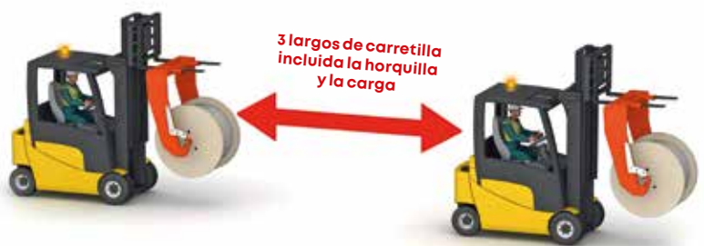
Figura 6. Distancia entre dos carretillas
