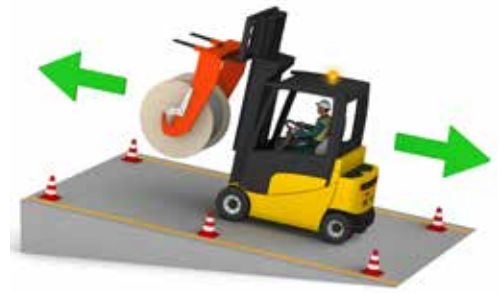
Figura 3. Circulación en pendientes.
