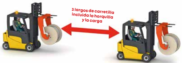
Figura 6. Distancia entre dos carretillas
