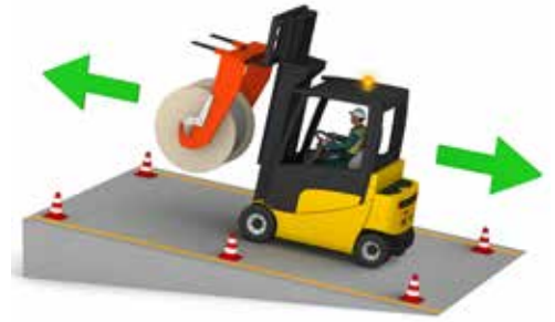
Figura 3. Circulación en pendientes.
