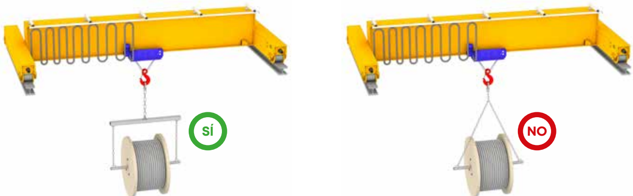
Figura 11. Posición correcta de las cadenas
