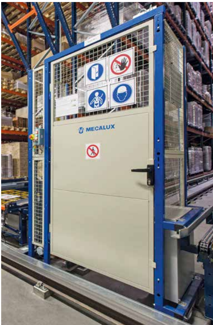
Cerramientos de zonas de control y mantenimiento
