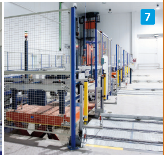
Las maniobras de entrada y salida de la mercancía a las cámaras a través de los SAS son gobernadas por los sistemas de gestión y control de Mecalux (Easy WMS y Galileo).
