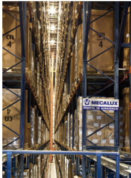
Pasillo de almacenaje con transelevador.
