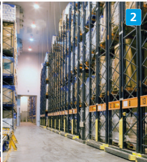
En las estanterías sobre bases móviles se almacenan los pedidos de media rotación o con palets de medidas variables.
