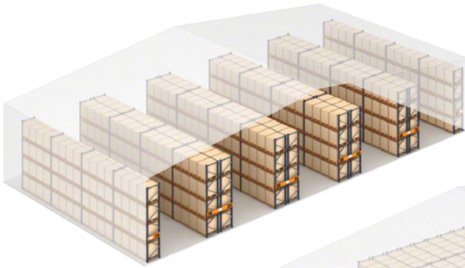
Almacén de paletización convencional
