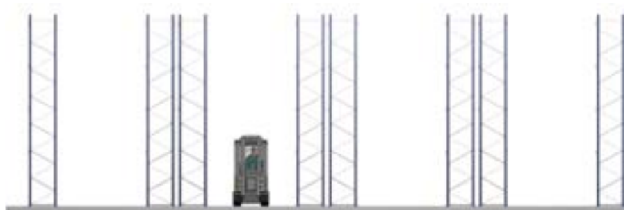
Sistema convencional más habitual, formado por una estantería sencilla adosada a la pared y estanterías dobles centrales
