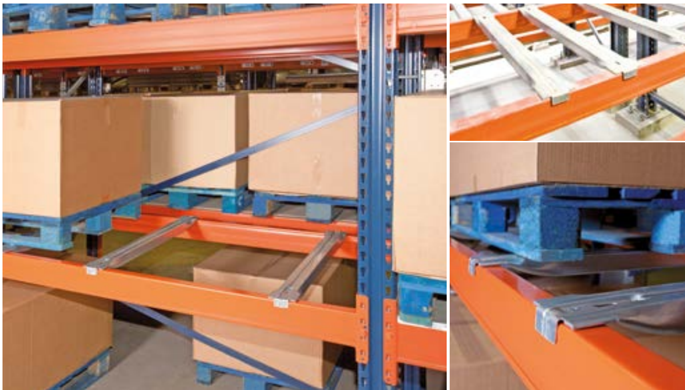
Detalles con travesaño para palet galvanizado
