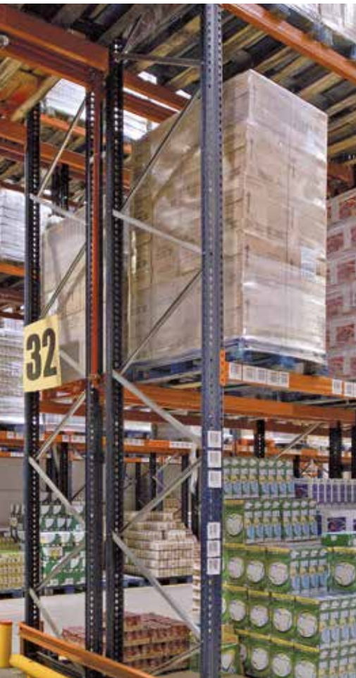
Almacén de paletización convencional con palets manipulados por el lado de 800 mm
