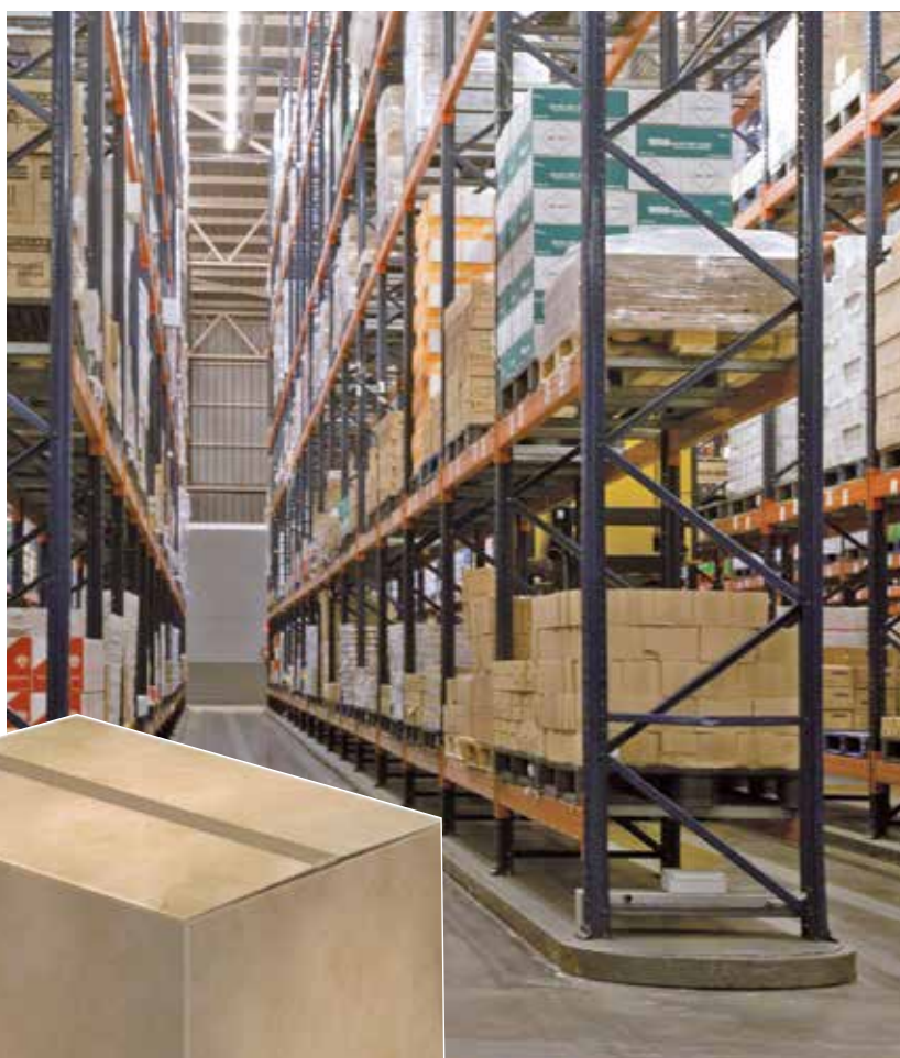
Arriba, almacén de paletización con palets manipulados por el lado de 1.200 mm
