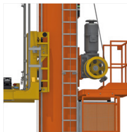
Escalera de mano y plataforma de mantenimiento superior
