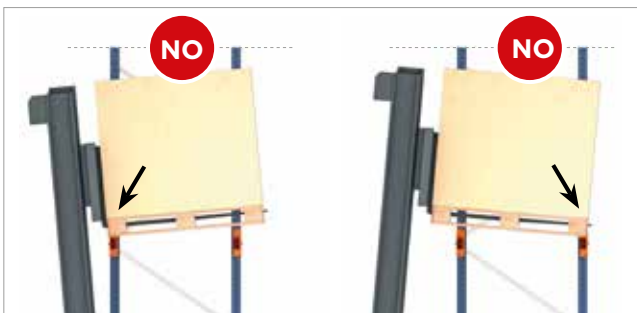
Figura 9. Sobrecarga sobre un larguero por descenso no horizontal
