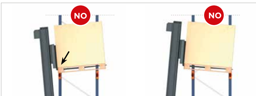
Figura 9. Sobrecarga sobre un larguero por descenso no horizontal
