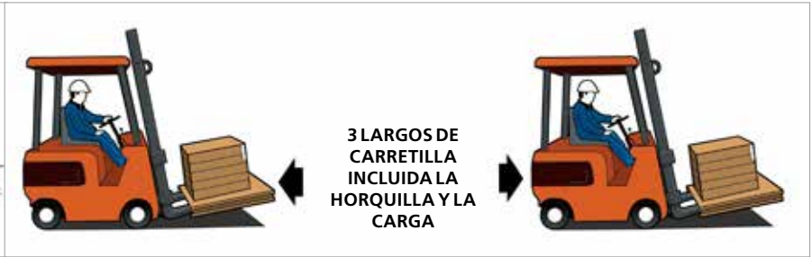
Figura 6. Distancia entre dos carretillas
