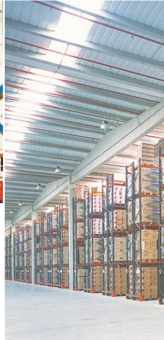
Arriba, almacén de paletización de 7 niveles de carga. Paleta manipulada por el lado de 1.200 mm.
