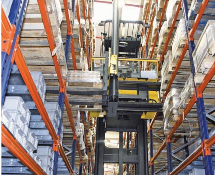
Horquilla en posición de depósito/extracción.
