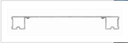
Los niveles pueden formarse únicamente con paneles metálicos, sin necesidad de colocar largueros. El tipo de panel utilizado, el HM, se apoya en las esquinas sobre cuatro soportes PK previamente enganchados en los taladros laterales de los puntales.
