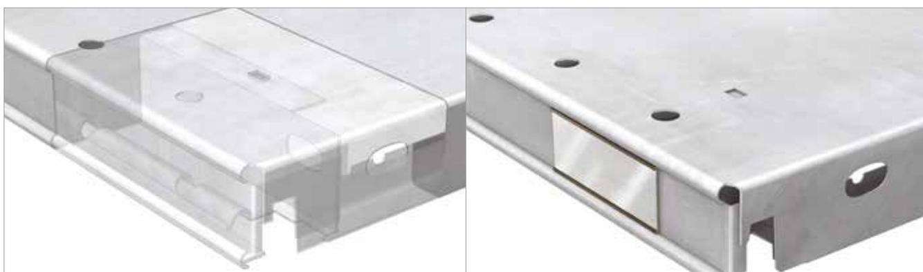
En los paneles HM, los distintos tipos de plegados de la parte delantera y trasera conforman un perfil en tubo cerrado y grapado con una gran capacidad de carga. Estos paneles pueden incorporar ranuras para la colocación de divisorias verticales y accesorios.
