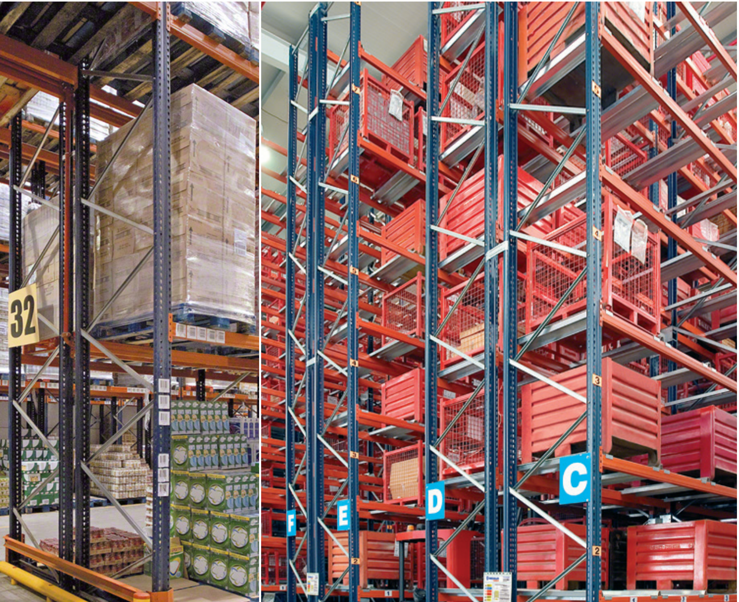
Almacén de paletización convencional con contenedores metálicos
