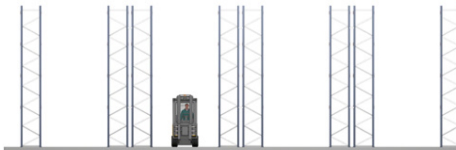
Sistema convencional más común formado por una estantería sencilla adosada a la pared y estanterías dobles centrales
