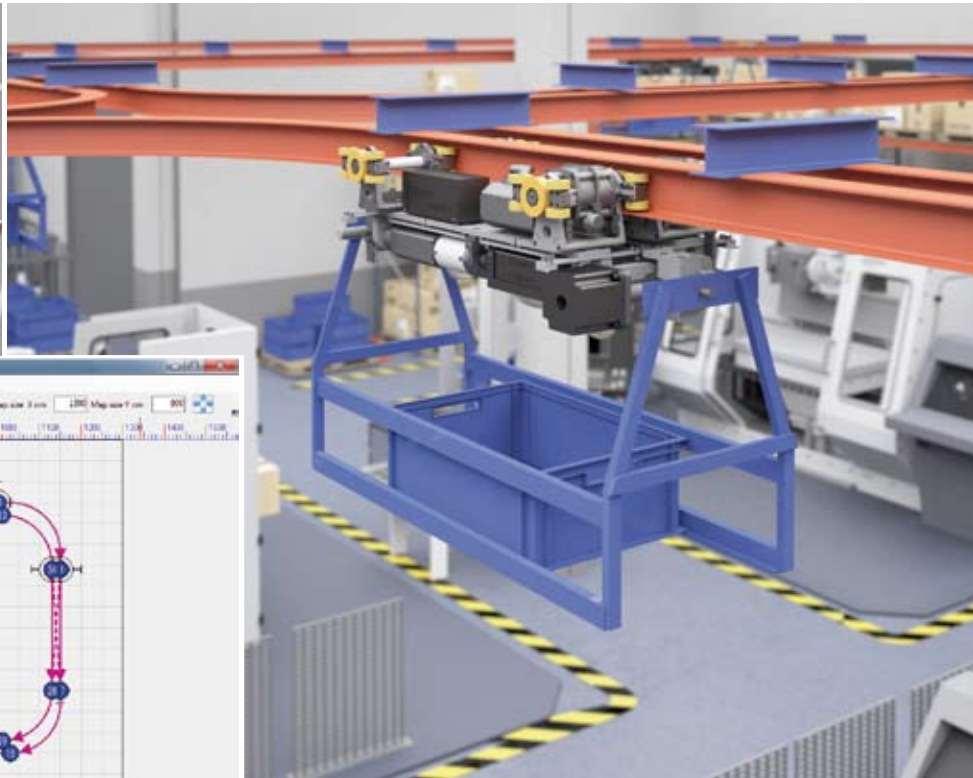
Ejemplo de un circuito con transportadores aéreos para cargas ligeras.
