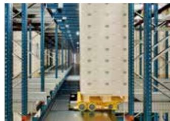
**3.** El carro llega al canal de almacenaje indicado, eleva ligeramente el palet y se introduce en el canal para depositarlo en la posición libre más profunda.
