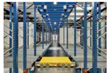
**4.** Tras depositar el palet, el *shuttle* sale del canal. Puede hacerlo por el mismo lado que entró o por el extremo opuesto pasando por debajo de los palets.
