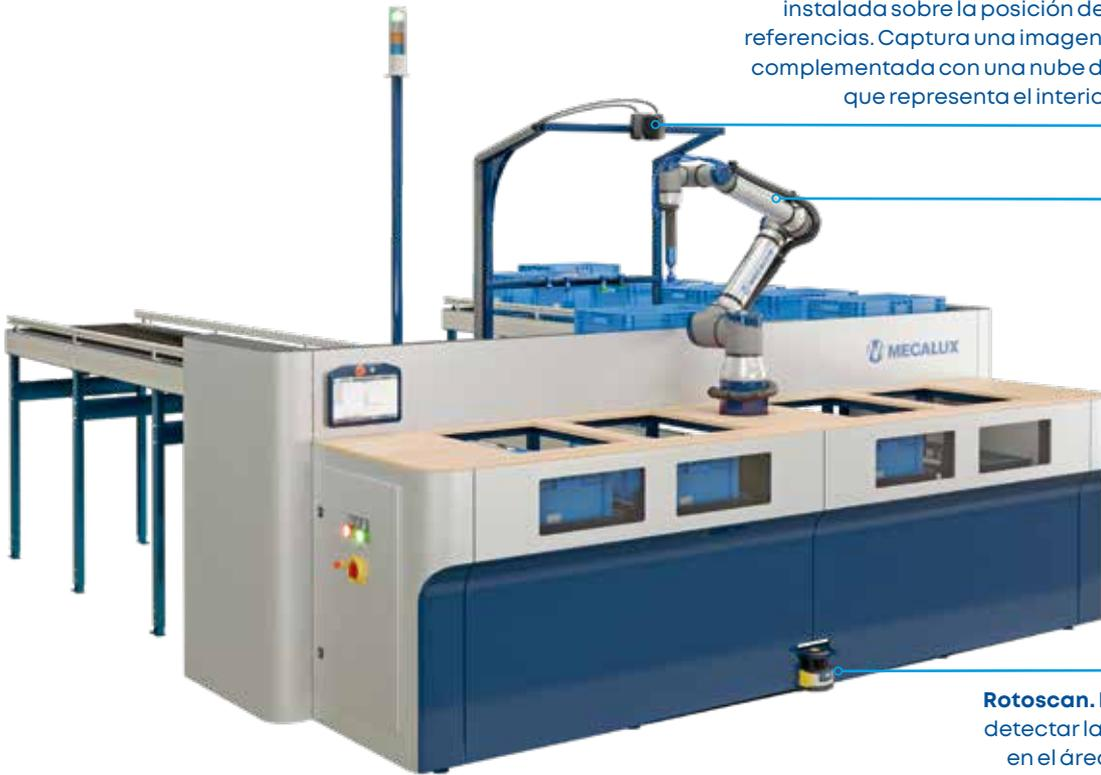
**Cámara.** Cámara de alta resolución, instalada sobre la posición de la caja con referencias. Captura una imagen 2D en color, complementada con una nube de puntos 3D que representa el interior de la caja.
