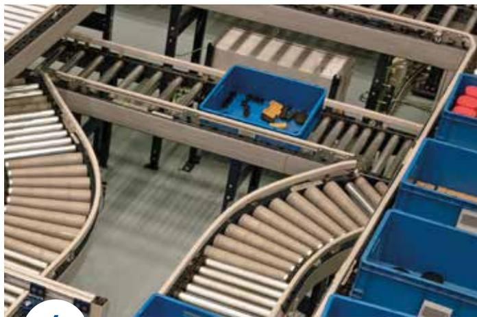
**Pedido preparado.** Una vez completado el picking, la caja de pedido se traslada mediante transportadores a otra zona del almacén (consolidación, expedición, etc.).
