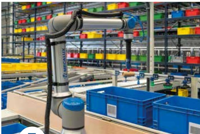
**Recogida y depósito del producto.** A partir de los datos proporcionados por el software de visión de Siemens, el brazo robótico recoge el producto seleccionado y lo deposita en la caja de pedido correspondiente.
