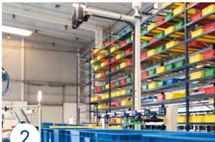
**Identificación del producto.** La cámara del sistema de visión toma una fotografía del interior de la caja que contiene las referencias. Luego, el software de visión analiza la fotografía obtenida para identificar la silueta del producto a recoger y determinar el mejor modo de hacerlo.
