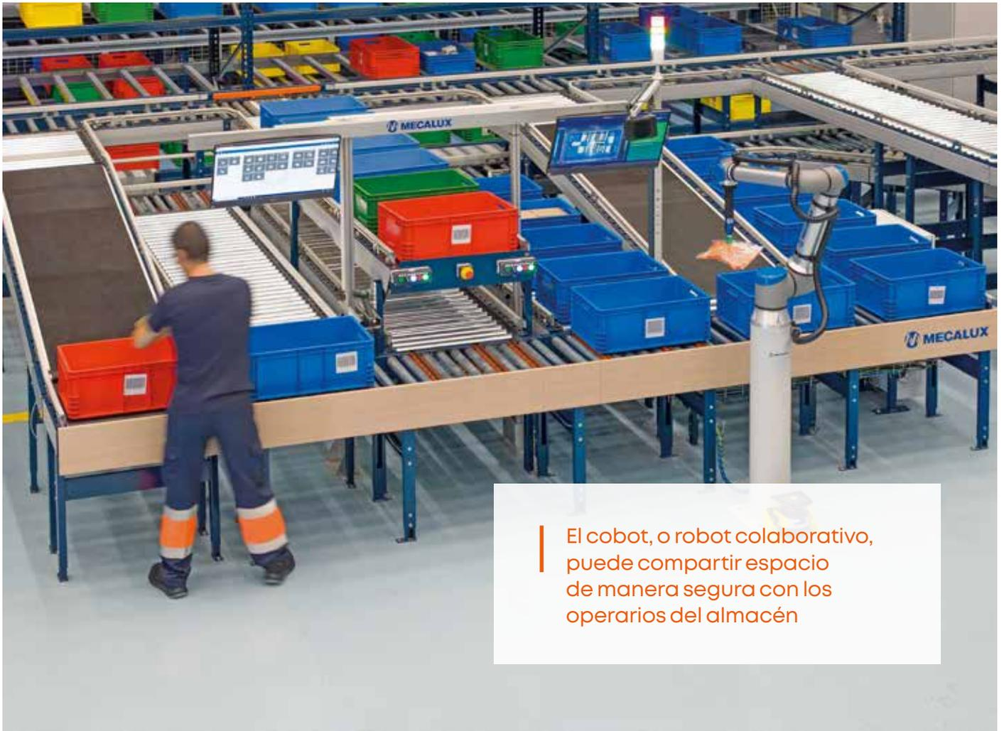
El cobot, o robot colaborativo, puede compartir espacio de manera segura con los operarios del almacén
