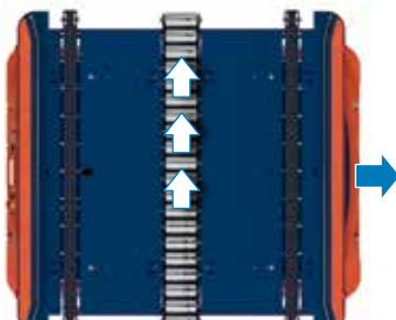
Transmisión de cargas lateral para europalets de 1.200 x 800/1.000/1.200 mm.
