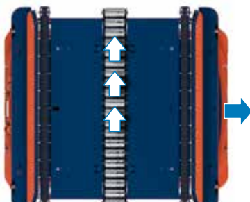
Transmisión de cargas lateral para europalets de 1.000 x 1.200 mm.
