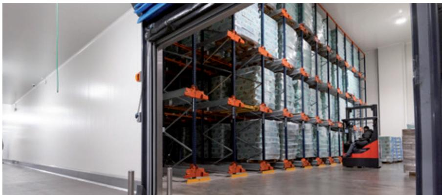
“El funcionamiento del Pallet Shuttle destaca por su simplicidad”, señala Dan Bellaiche. El carro automático es el encargado de desplazar la carga hasta la primera ubicación libre dentro del canal. Mientras el Pallet Shuttle traslada y deposita el palet, el operario coloca otro palet en la primera posición del mismo canal. De esta forma, cuando el Pallet Shuttle regresa al inicio de la calle, puede repetir el mismo movimiento sucesivamente.
