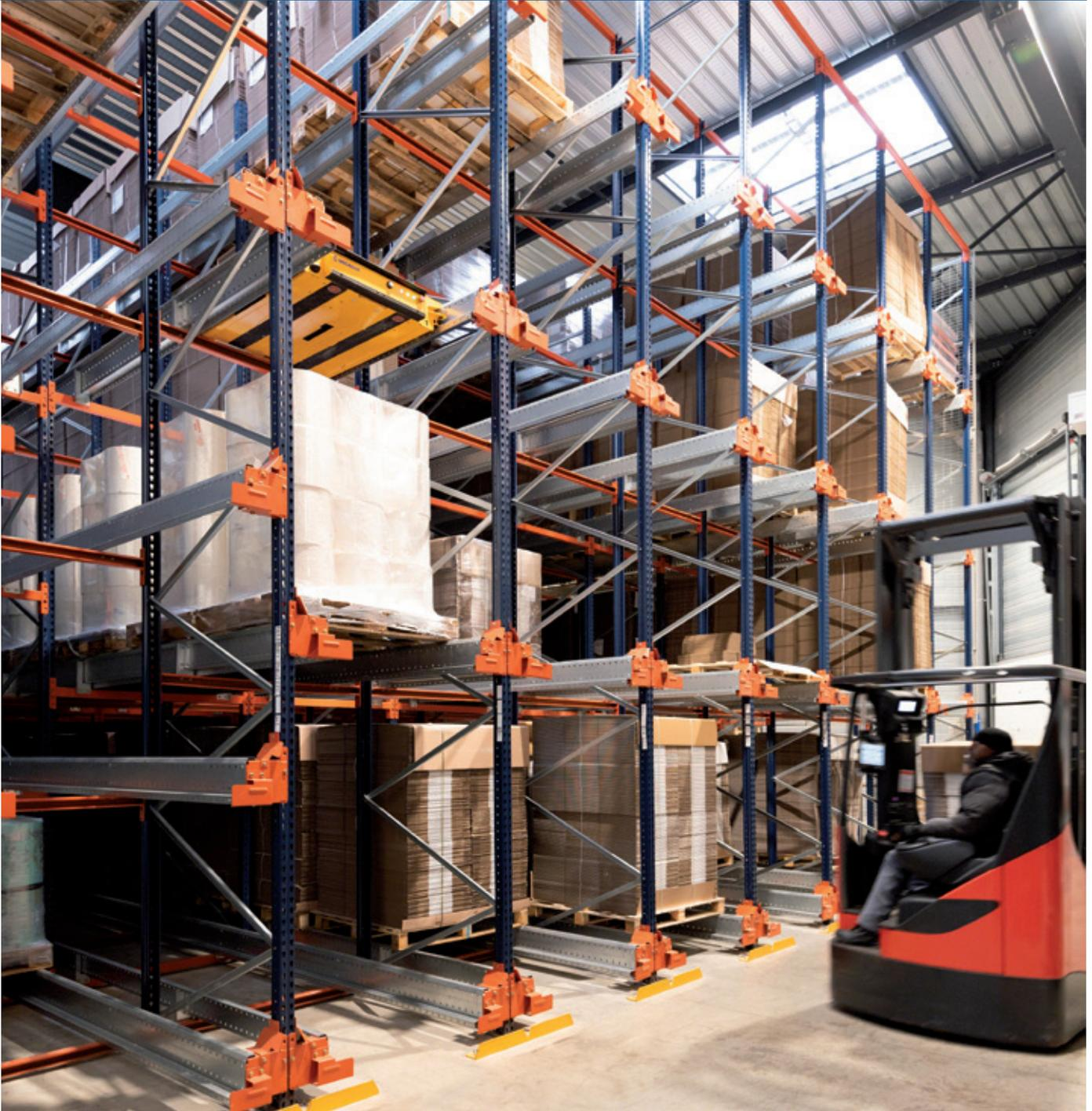
Les Mille Et Une Feuilles, empresa francesa fabricante de hojas de brick, ha estrenado un nuevo almacén con estanterías compactas con el sistema Pallet Shuttle de Mecalux. Esta instalación tiene una doble función: enviar las materias primas a producción y almacenar los productos terminados. El Pallet Shuttle, al ser una solución semiautomática, brinda mucha rapidez a las entradas y salidas de los productos.
