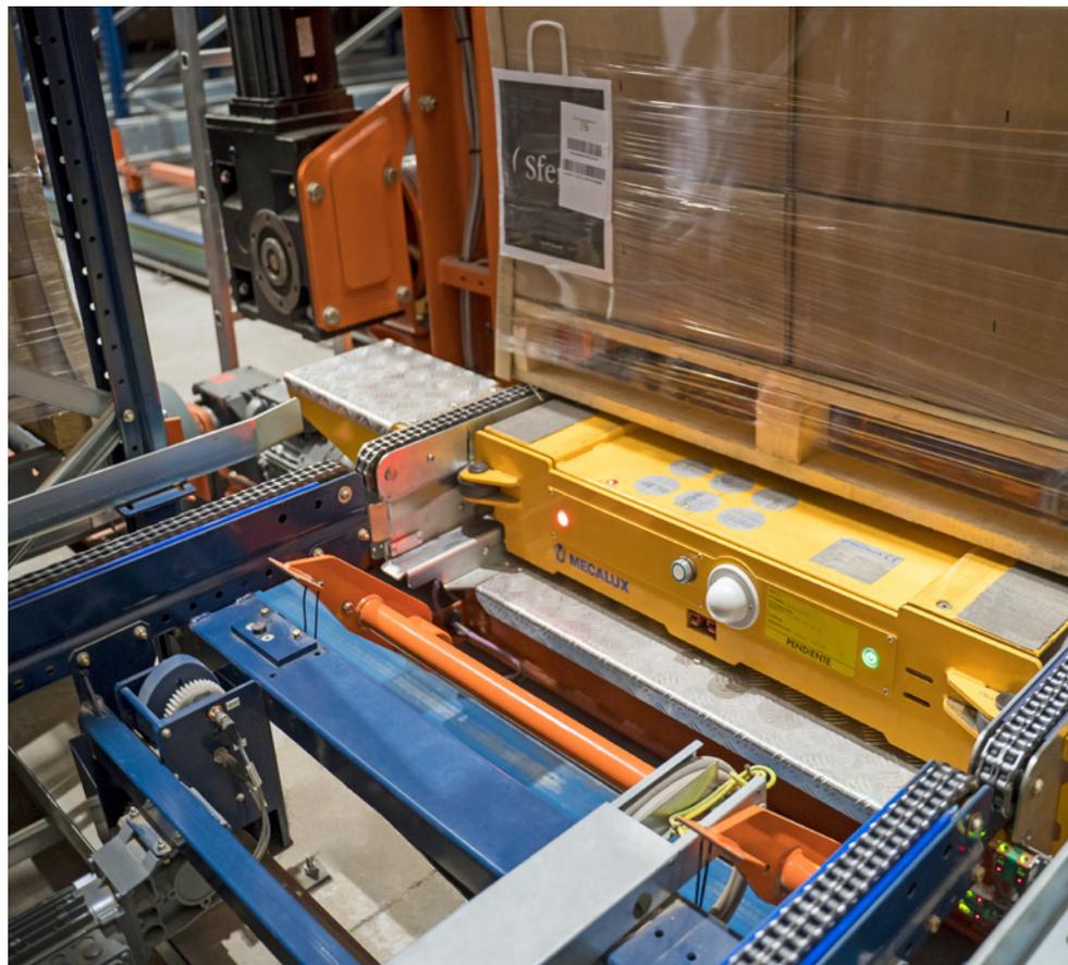
de longitud donde circula un transelevador. Uno de los bloques tiene profundidad para cinco palets y el otro, para 33. En total, se almacenan 4.990 palets con un peso máximo unitario de 600 kg. El transelevador recoge los palets y los lleva hasta el canal de almacenaje correspondiente. Es entonces cuando un carro eléctrico los traslada hasta la posición libre más profunda dentro del canal.
