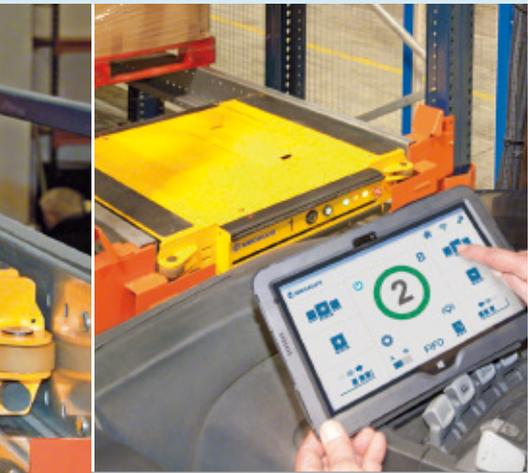
Ejemplo de aplicación de un almacén de acumulación con Pallet Shuttle que dispone de dos transportadores, uno de entrada y otro de salida. Así se optimizan los tiempos de ejecución de los operadores.
