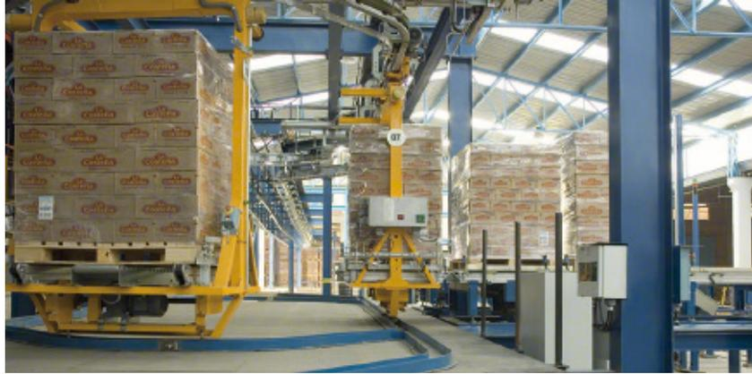
Las electrovías son un transporte de mercancía alternativo mediante vehículos con mandos individuales que se mueven por un carril en forma de "I". El carril está suspendido del techo de la nave o fijado al suelo mediante estructuras tipo pórtico. Resultan muy útiles cuando se han de unir puntos distantes y se requieren flujos de transporte rápidos.
