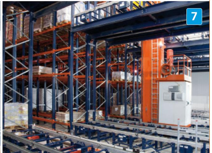
La zona de picking automático dispone, del robot pòrtico de dos ejes, de lanzaderas y transportadores automáticos para conseguir los flujos requeridos.
