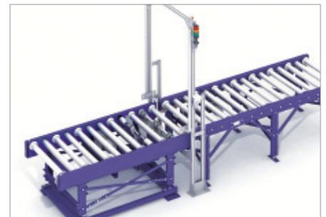
**Puesto de inspección de entradas.** El puesto de inspección y control de entradas se instala en aquellos casos en los que se tenga que comprobar que las dimensiones, el peso y el estado de los palets cumplan con las especificaciones de la instalación, especialmente cuando el sistema de transporte se utiliza para introducir palets en un almacén automático.
