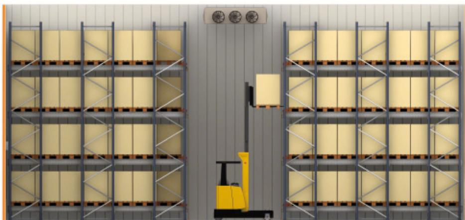
El funcionamiento semiautomático del sistema de acumulación con Pallet Shuttle facilita que el almacenaje de la carga sea rápido y muy preciso. La carretilla deja la carga sobre los carriles y el Pallet Shuttle la desplaza sobre ellos, de forma autónoma, depositándola en su ubicación. El operador ordena los movimientos de carga y extracción a través de un mando de radiocontrol.
