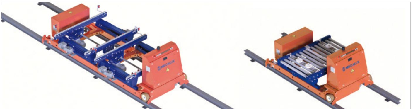
**Lanzadera.** Sistema de transporte no continuo de unidades de carga. Consiste en un carro que se traslada sobre guías en una trayectoria recta y en varios puntos intermedios. Su longitud se adapta a la distancia a cubrir dado que se monta sobre guías independientes sobre el suelo o empotradas. Necesita como complemento un mínimo de dos transportadores de rodillos o cadenas, colocados perpendicularmente al sentido
