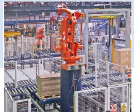
**Picking automático con robot despaletizador**
