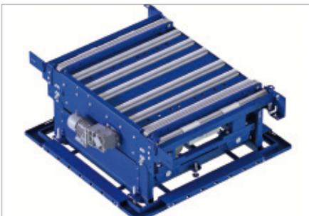
**Transportador mixto de rodillos y cadenas.** Cambio de dirección a 90° en el avance de las unidades de carga con entrada en el transportador de rodillos y salida en el de cadenas o viceversa. Para llevar a cabo esta operación, combina un transportador de rodillos fijo en la bancada y un transportador de cadenas sobre un bastidor de elevación excéntrica.
