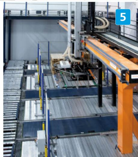
El robot de picking automático permite preparar pedidos de los productos de alta rotación por mantos. Los palets son alimentados mediante los transelevadores y los transportadores de la cámara automática.
