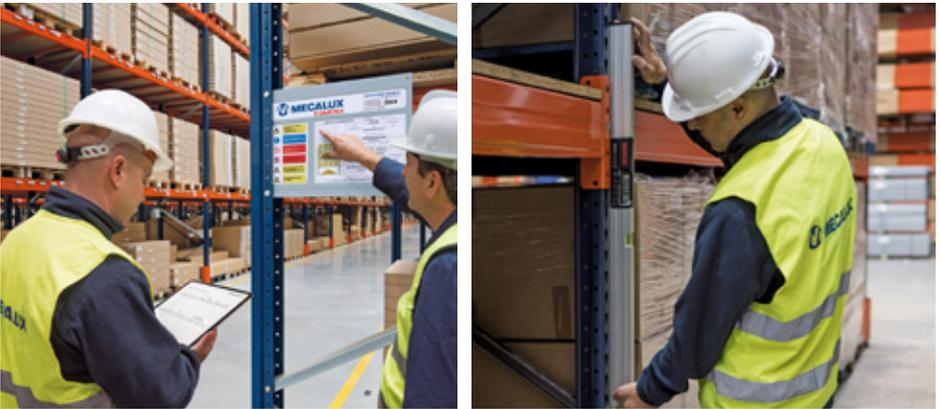
NUESTROS TÉCNICOS REALIZAN UNA RIGUROSA INSPECCIÓN DE LA INSTALACIÓN, VERIFICANDO EL ESTADO DE LAS ESTANDEFERÍAS Y DEL ALMACÉN EN GENERAL.
