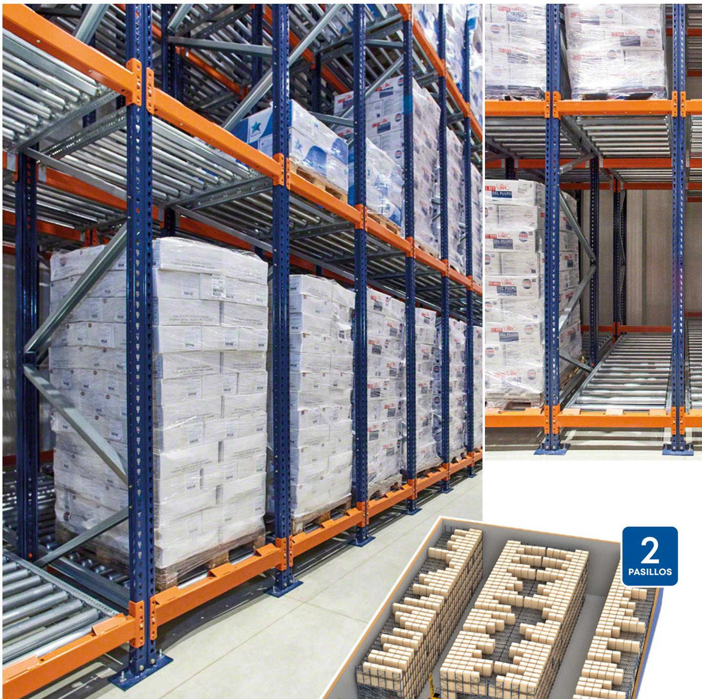
• Sin embargo, si en su lugar se instala un sistema push-back con rodillos (imagen 6.2), la capacidad de almacenaje se incrementa, ya que pueden ubicarse **hasta seis palets en profundidad** y, por lo tanto, sólo se precisan dos pasillos en lugar de los cuatro que se requieren en una instalación con carros.
