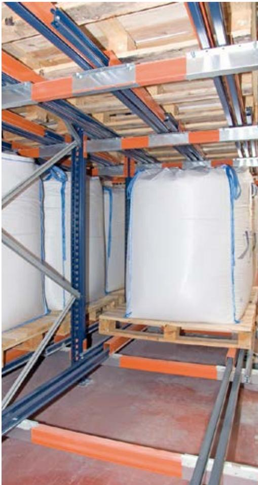
Además de los elementos comunes de las estanterías metálicas para paletización (como los bastidores, largueros, travesaños, diagonales, anclajes, etc.), lo que distingue al sistema push-back son los carriles de rodadura, los carros y diversos dispositivos de seguridad:
