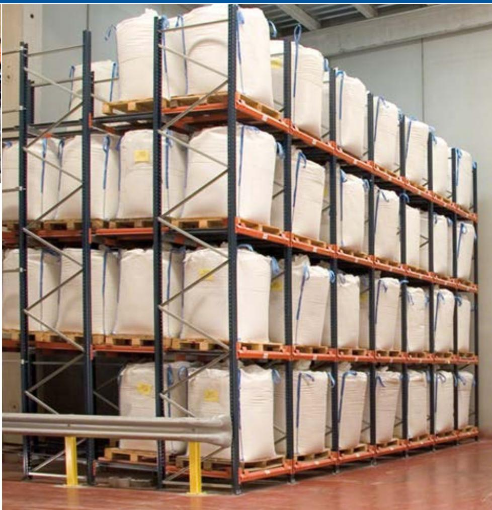
En las estanterías push-back la carretilla elevadora manipula los palets con los patines inferiores dispuestos perpendicularmente, para que estos se apoyen de manera transversal en los carros y carriles.
