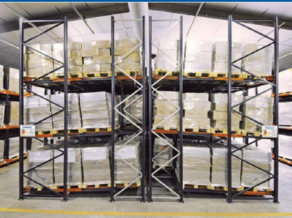
2. **Varios niveles de picking dinámico en el nivel inferior**, que pueden abastecerse tanto de palets procedentes de los niveles superiores, como de cajas extraídas previamente de dichos palets (figura 2).
