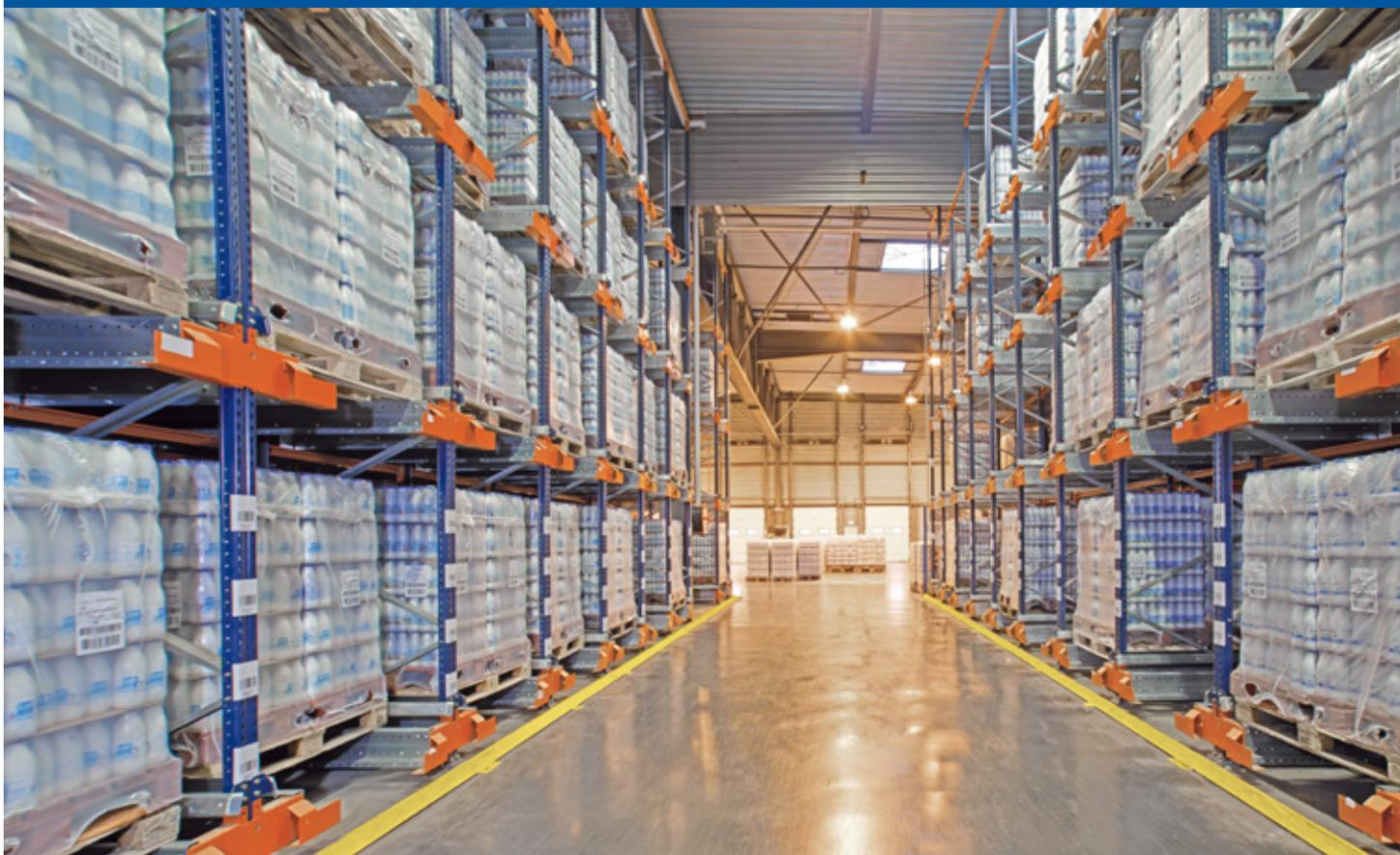
En las instalaciones semiautomáticas con Pallet Shuttle, las carretillas depositan los palets sobre los carriles en la entrada del nivel y el carro eléctrico los recoge y los desplaza hasta la primera ubicación libre en el canal, compactando así al máximo la carga.
