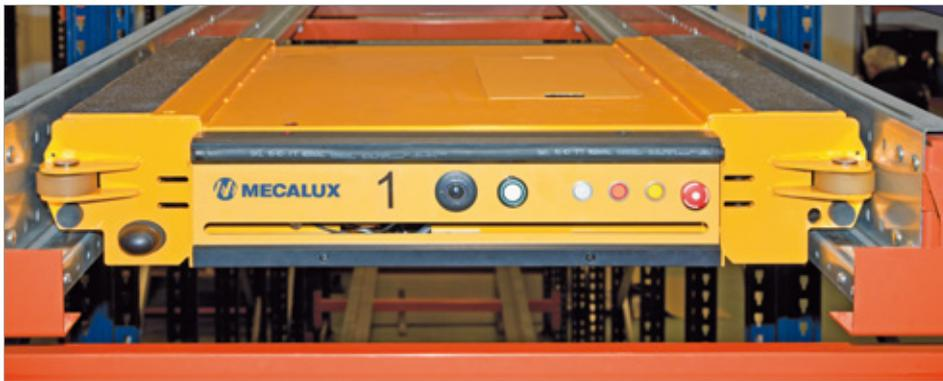
Las **baterías de litio** son de fácil acceso e incluyen conexiones rápidas que eliminan la necesidad de cables, de modo que se pueden cambiar rápidamente sin interrumpir el ciclo de trabajo.
