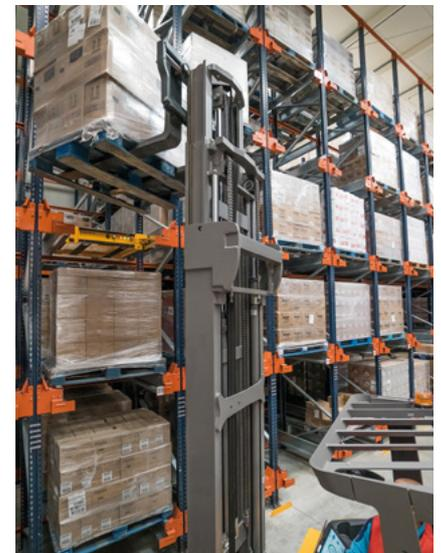
Cuando se dispone de varios canales con la misma referencia, se puede realizar un FIFO por cada canal de carga o lote, siguiendo un orden de vaciado y llenado de los canales.
