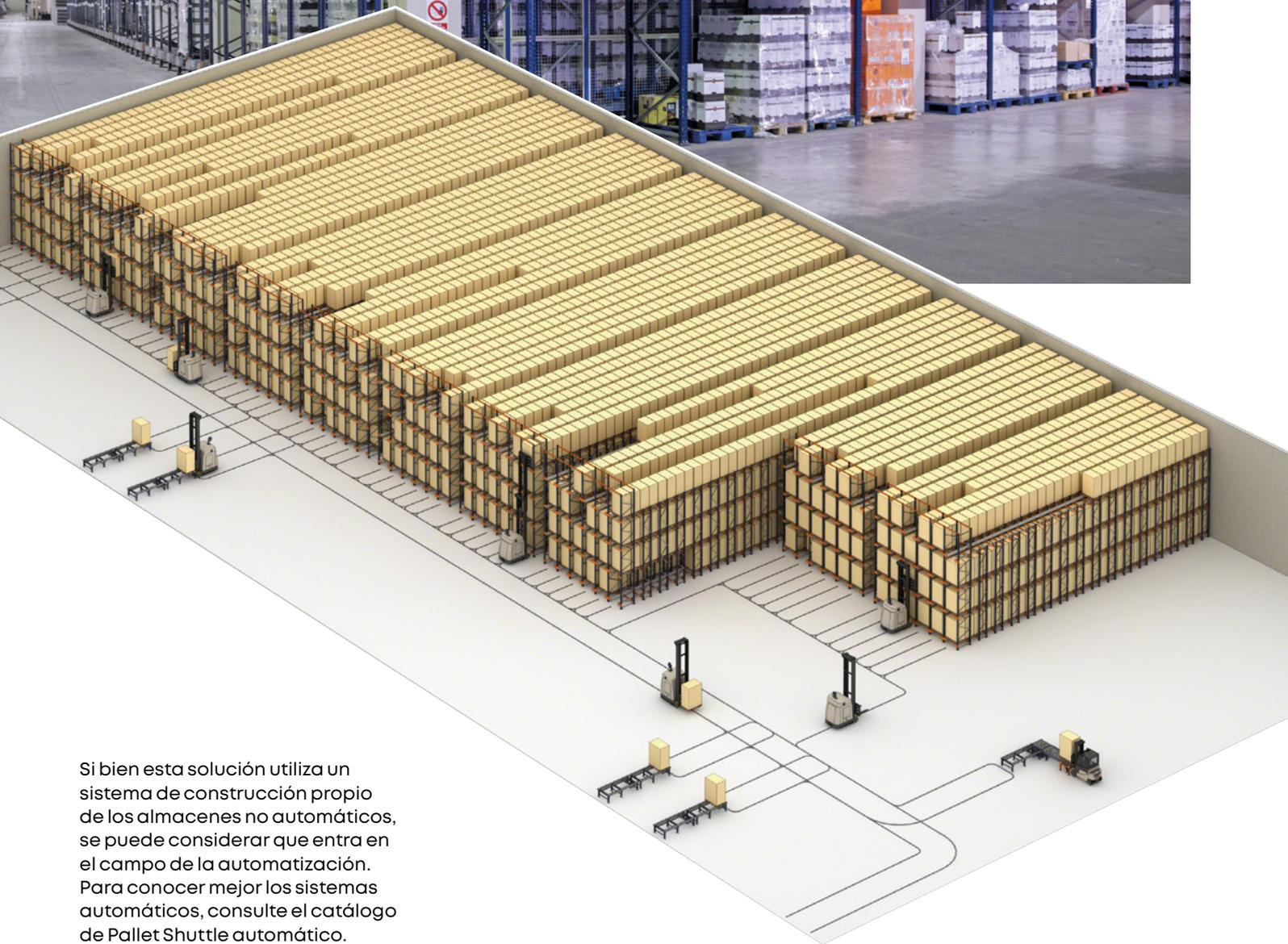
Si bien esta solución utiliza un sistema de construcción propio de los almacenes no automáticos, se puede considerar que entra en el campo de la automatización. Para conocer mejor los sistemas automáticos, consulte el catálogo de Pallet Shuttle automático.
