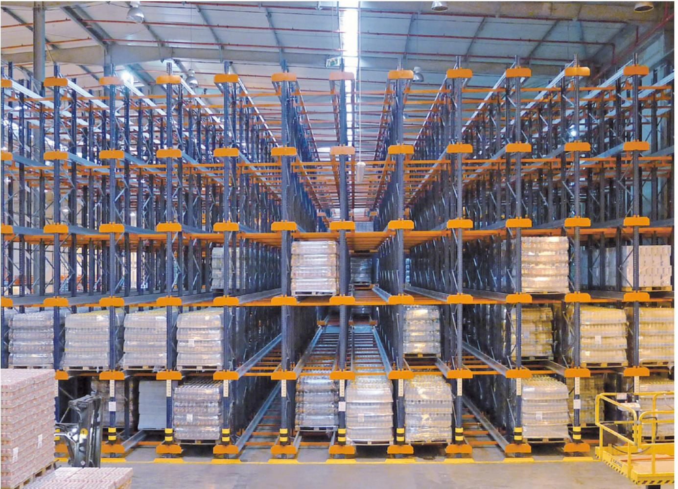
El sistema Pallet Shuttle también es un recurso frecuente en combinación con estanterías o niveles para realizar picking. Existen diversas posibilidades para habilitar canales de picking bajo una estructura de estanterías con Pallet Shuttle:
