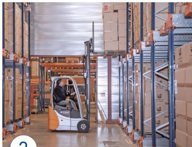
A continuación, la carretilla coloca los palets de uno en uno en la entrada del canal, apoyándolos sobre los perfiles de carga. La carretilla nunca entra en la estructura de las estanterías.
