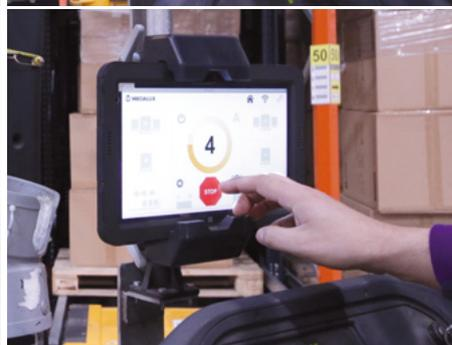
Para poder acceder al tablet desde una posición ergonómica y segura, existe un soporte que se fija directamente a la estructura de protección de la carretilla, en la parte superior (techo) o en uno de los perfiles verticales de sustentación. Así, el tablet se encaja en la bandeja del soporte y puede extraerse fácilmente.
