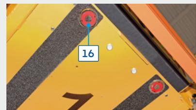
**Sistema de bloqueo (16):** asegura la fijación del carro sobre las palas de la carretilla, evitando que se mueva durante su desplazamiento.
