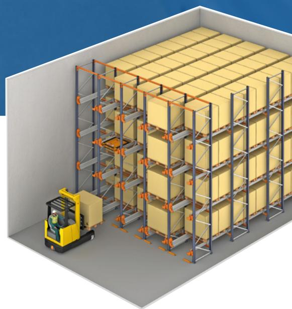
El carro realiza los movimientos de forma autónoma, sin necesidad de que las carretillas elevadoras entren en las calles de almacenaje, siguiendo las órdenes lanzadas por un operario a través de un tablet con conexión wifi.
