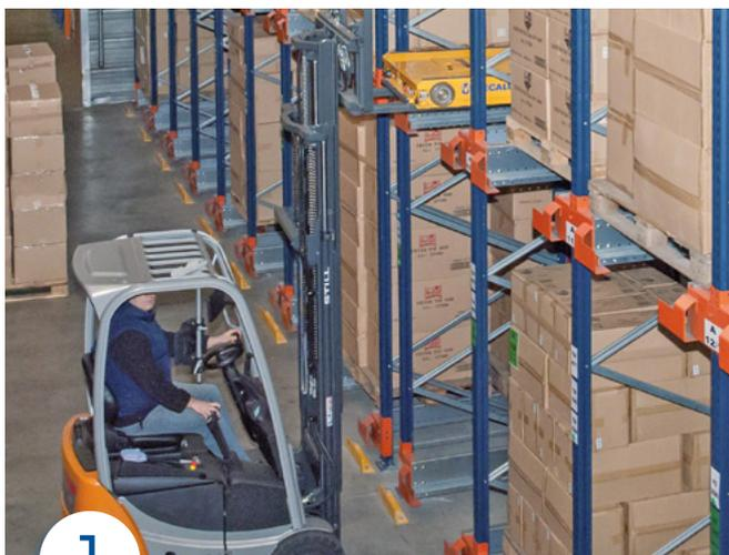
La carretilla elevadora deposita el carro Pallet Shuttle en el canal donde se desea operar.
