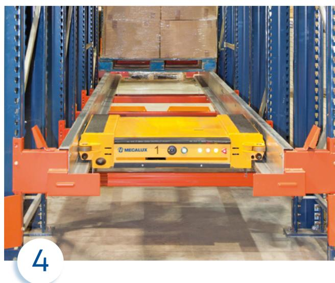
El carro vuelve al inicio del canal para repetir el movimiento con el siguiente palet y así sucesivamente hasta llenar el canal. Antes de ocupar la última ubicación, se retira el carro y se repite la secuencia en el siguiente canal donde se necesite operar.
