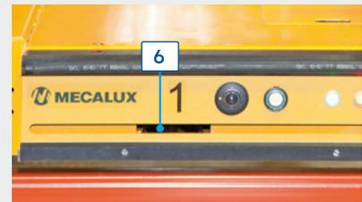
**Escáner de seguridad (opcional) (6):** se instala a cada lado del Pallet Shuttle, para controlar de forma más segura el acceso a los canales mientras el carro está operando.
