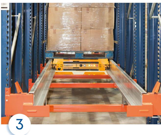
Mediante el tablet con conexión wifi, el operario da la orden correspondiente para que el carro inicie la operación de carga. Una vez identificada la posición del palet, el carro eleva ligeramente el palet sobre sí mismo y después lo desplaza horizontalmente hasta llegar a la primera ubicación libre, donde lo depositará. Diferentes sensores controlan con gran precisión el movimiento del carro con la carga.
