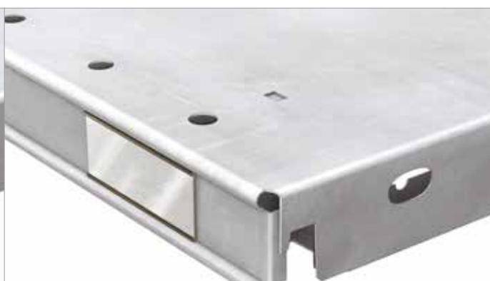
En los paneles HM, los distintos tipos de plegados de la parte delantera y trasera conforman un perfil en tubo cerrado y grapado con una gran capacidad de carga. Estos paneles pueden incorporar ranuras para la colocación de divisorias verticales y accesorios.
