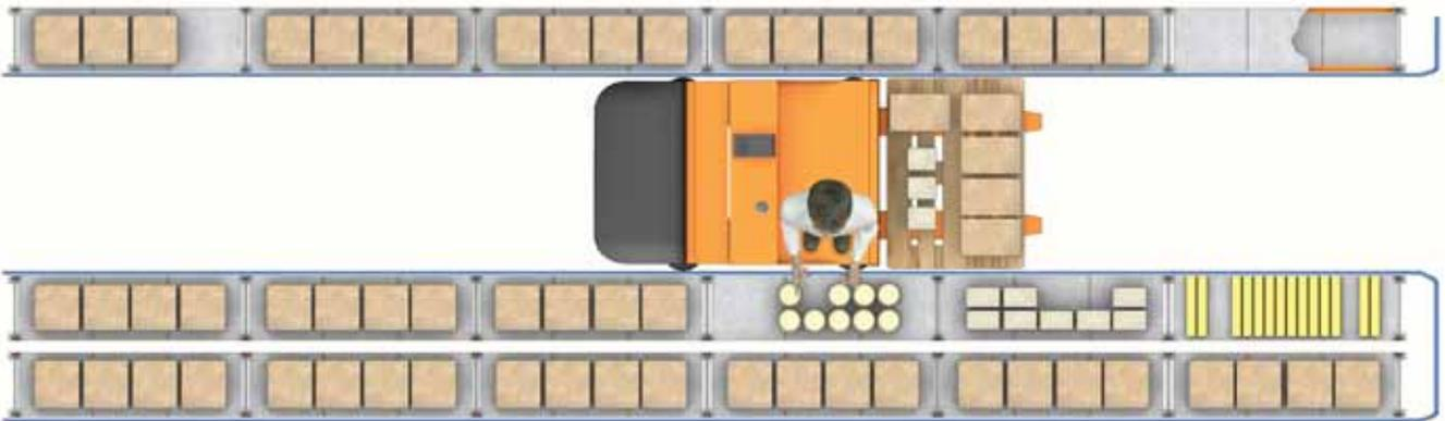
Cada modelo de máquina necesita un tipo de carril guía y un ancho de pasillo diferente. El ancho del pasillo viene definido por la distancia entre los carriles guía y la distancia entre los niveles de carga.
