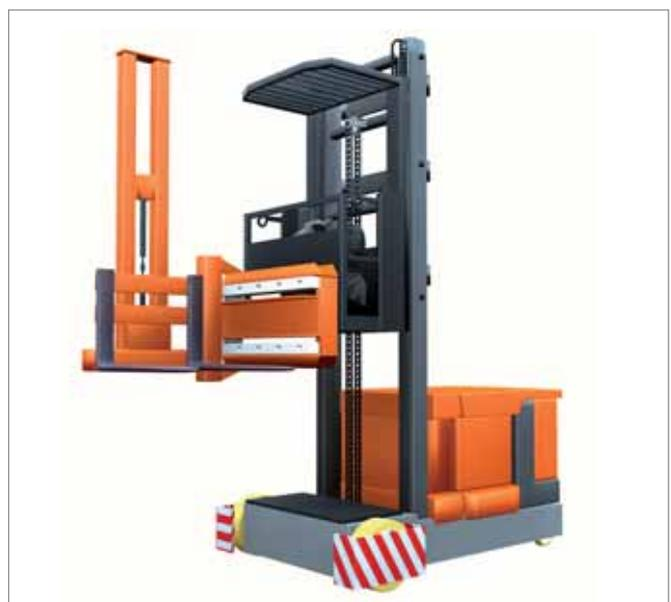
Las carretillas recogepedidos, al igual que las de tipo torre, necesitan ir guiadas por el interior de los pasillos de almacenaje.
