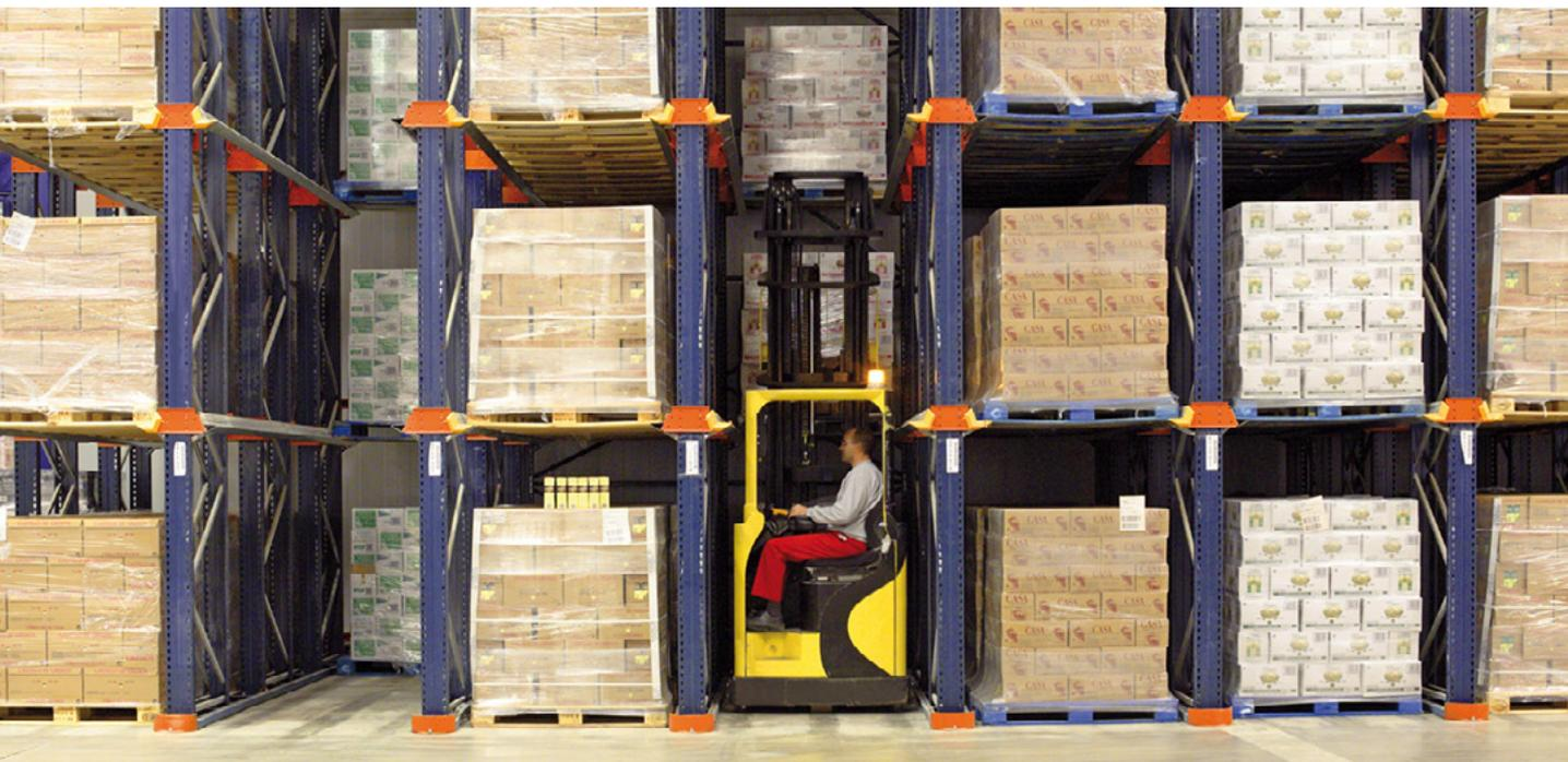
Al circular las carretillas por el interior de las calles de almacenaje, hay que calcular los márgenes necesarios para que puedan trabajar con seguridad. Existen ciertas medidas que deben tenerse en cuenta a la hora de diseñar la instalación:
