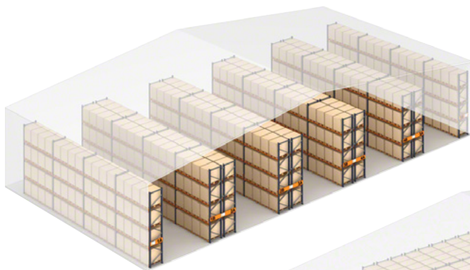
Almacén de paletización convencional
