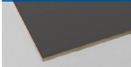
Formado por tableros de madera aglomerada de 30 mm de espesor que se presentan machihembrados, por lo que su colocación es rápida y las juntas quedan perfectas sin precisar piezas de empalme. Ambas caras poseen un acabado en melamina, blanca en la parte inferior y negra con acabado rugoso en la zona superior, lo cual le otorga cualidades antideslizantes, resistencia a la abrasión, un acabado más estético y mayor luminosidad de la zona inferior.
