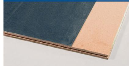
El piso de tablero aglomerado de madera puede recubrirse con chapa galvanizada de 1,5 mm de espesor cuando sobre la entreplanta vaya a circular algún tipo de transpaleta o carro pesado y quiera evitarse el desgaste del tablero, así como minimizar el ruido del desplazamiento.
