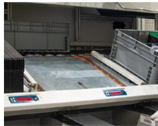
3. Después de extraer todos los productos necesarios, las cajas de la parte superior de la estación de picking se retiran automáticamente y regresan al almacén.
