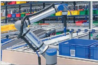
**Brazo.** Brazo robótico compacto de alto rendimiento en cuyo extremo se integra el dispositivo de agarre. Ofrece una gran eficiencia operativa y un largo alcance de hasta 1.300 mm.
