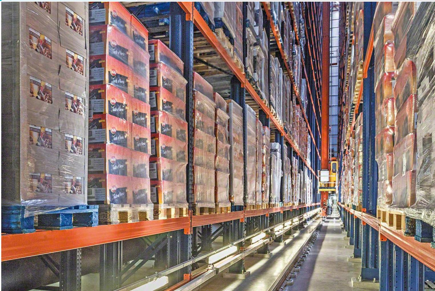
Los transelevadores son máquinas creadas para el almacenamiento automático de materiales mediante movimientos mecánicos automatizados. Las entradas y salidas de la carga se ejecutan en un mismo movimiento (ciclo combinado). Esto incrementa la productividad de las instalaciones al mismo tiempo que disminuye los recursos requeridos para su funcionamiento.
