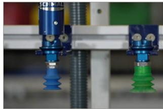
**Dispositivo de agarre.** Garra de vacío versátil y ligera que se adapta a artículos de distintas formas, superficies, pesos y dimensiones. Garantiza una perfecta sujeción del producto, así como una delicada manipulación.
