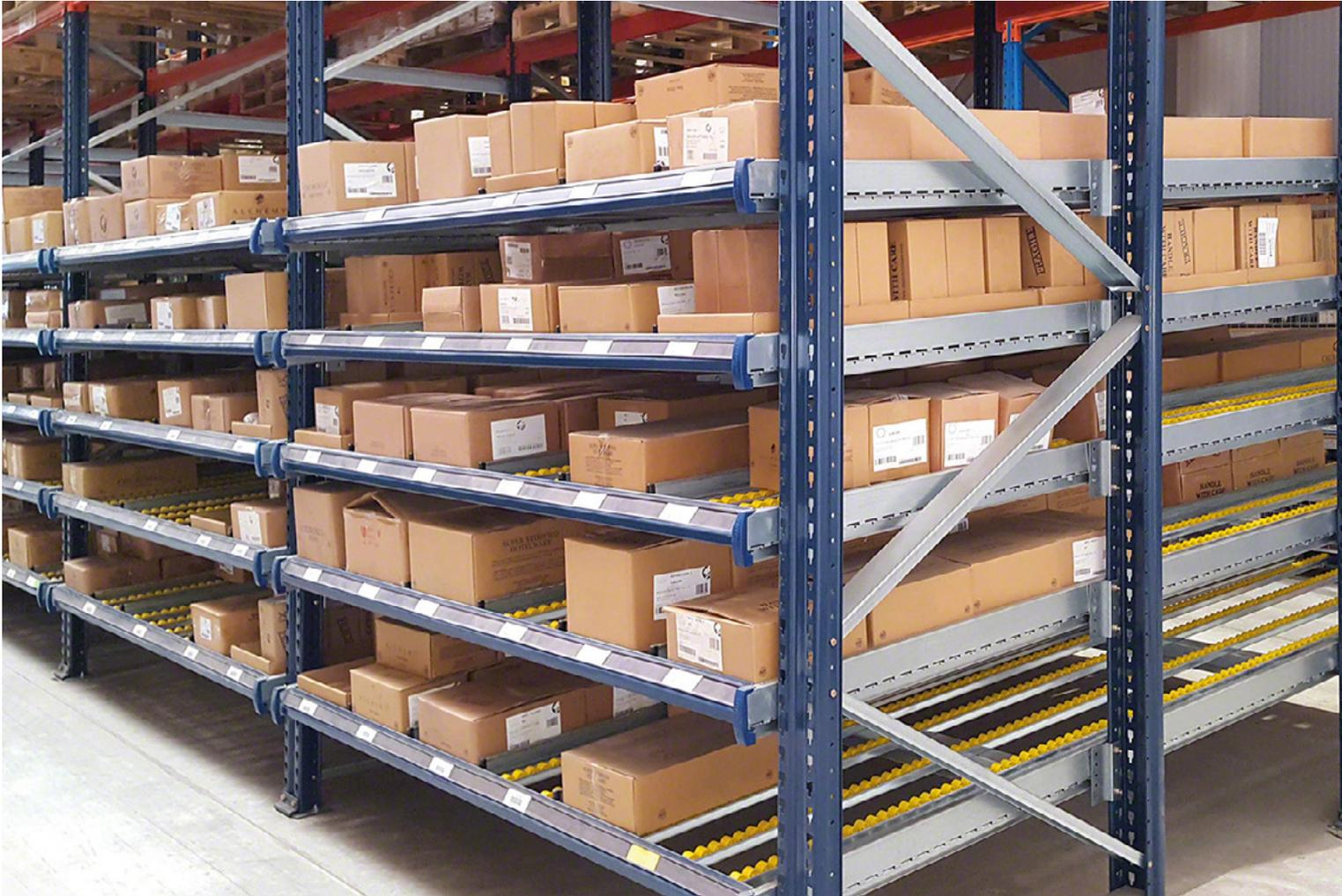
En las estanterías para picking dinámico, la mercancía se almacena sobre plataformas de roldanas o rodillos, diseñados en plano inclinado de modo que la mercancía se introduce por un lado y se desliza, por gravedad, hasta el lado contrario que da al pasillo de salida.
