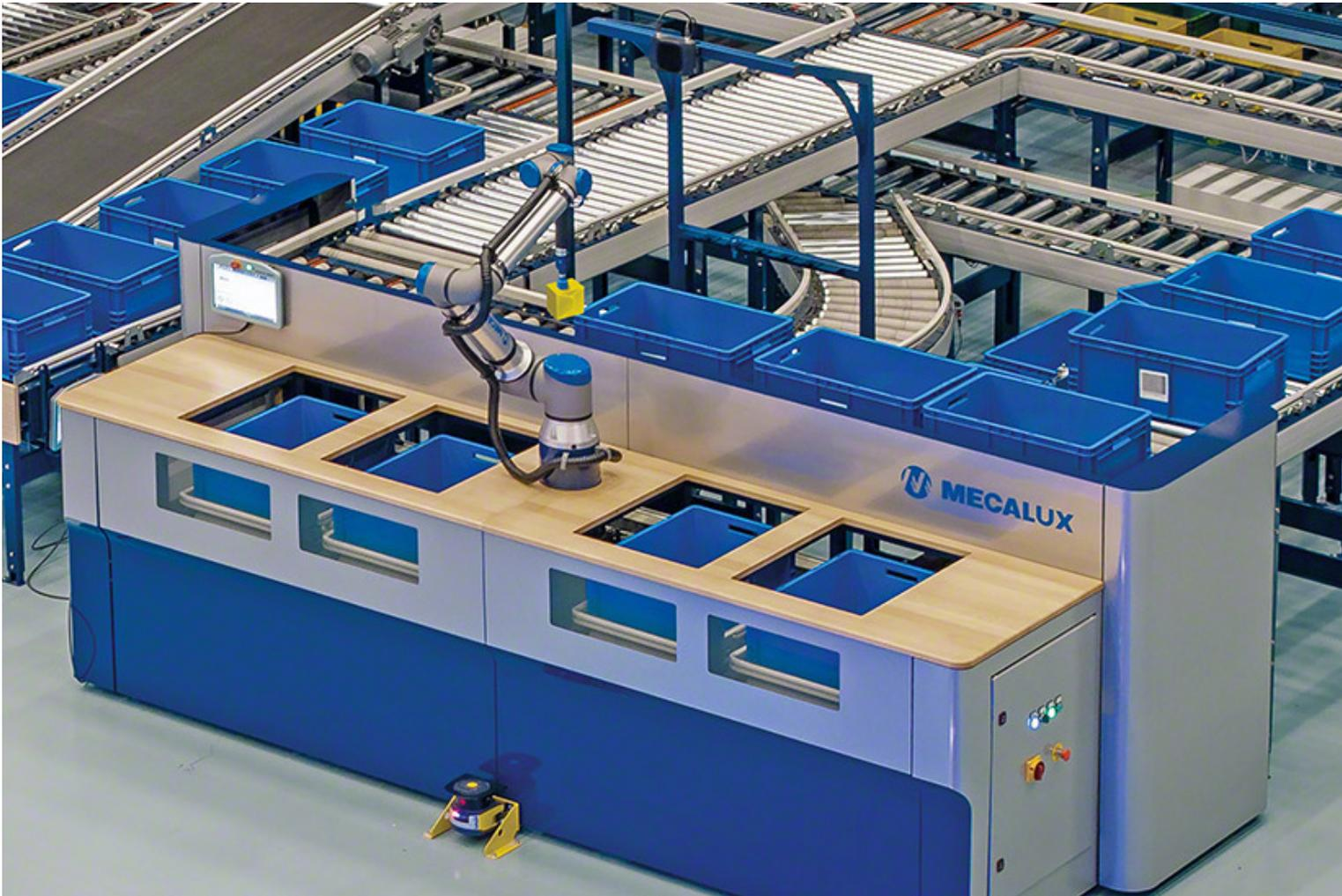
Cobot de *pick and place* diseñado para automatizar la preparación de pedidos. Se encarga de recoger productos de una caja de almacenaje y depositarlos en otra de modo completamente autónomo. Gracias a un innovador software de visión basado en algoritmos de *deep learning* y a un dispositivo de agarre de gran polivalencia, el robot manipula con absoluta precisión una amplia variedad de artículos de diferentes formas, superficies y dimensiones.
