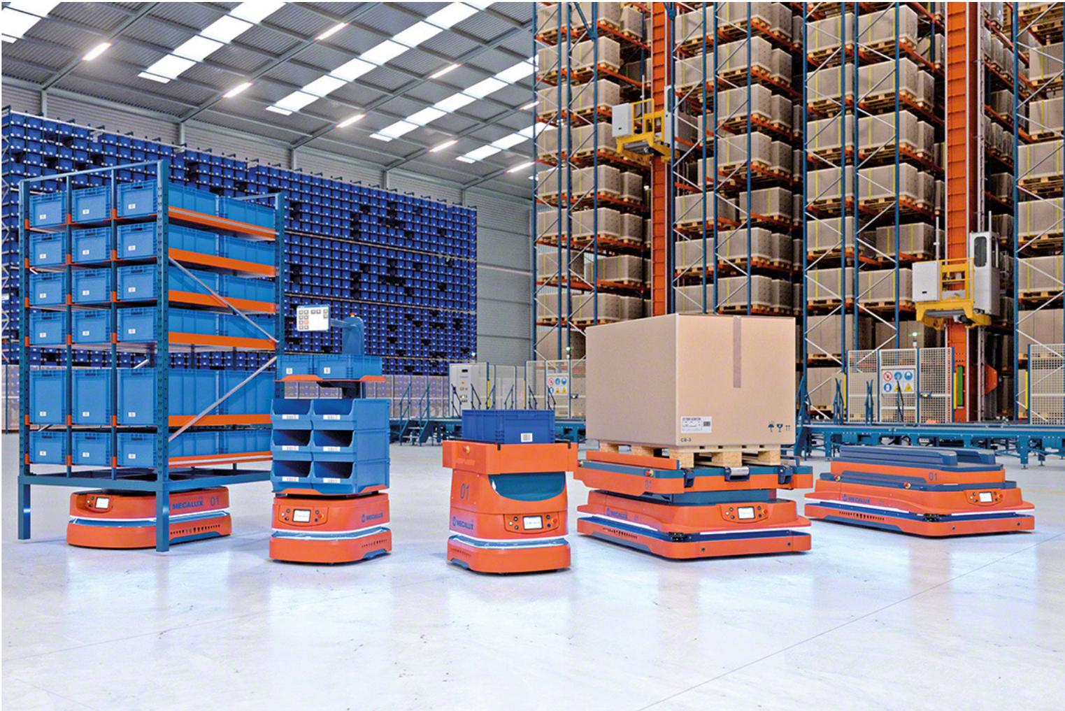
Vehículos diseñados para transportar cargas entre dos puntos con total independencia. Navegan libremente por el almacén a partir de rutas dinámicas generadas por un software inteligente que optimiza sus movimientos y asigna la trayectoria perfecta para cada tarea. Gracias al uso de sensores y escáneres de última generación, son capaces de identificar y esquivar obstáculos y de operar con seguridad en entornos colaborativos junto a personas y otras máquinas.
