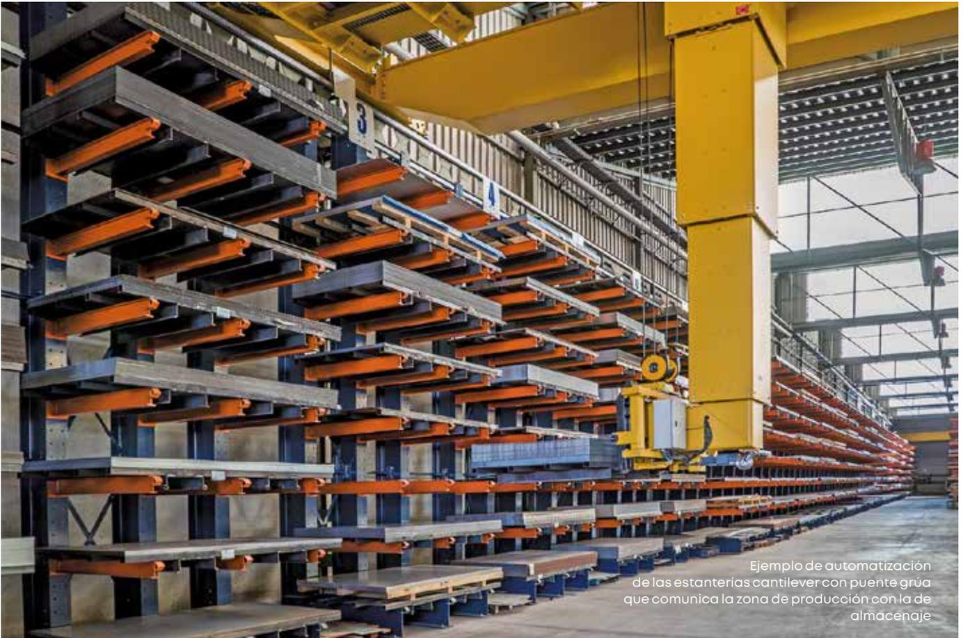
Ejemplo de automatización de las estanterías cantilever con puente grúa que comunica la zona de producción con la de almacenaje
