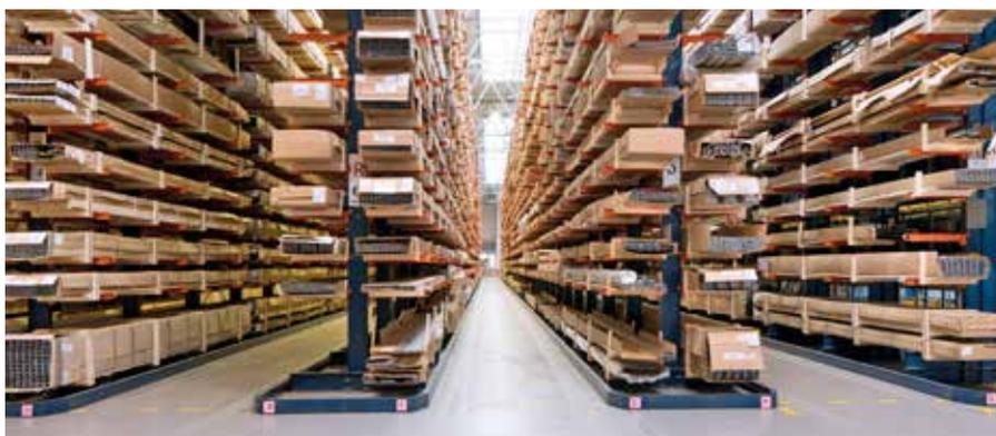
Están formadas básicamente por perfiles verticales (columnas) y perfiles horizontales (bases), que se colocan como soporte para aportar estabilidad, así como por brazos en voladizo sobre los que se deposita la carga.
