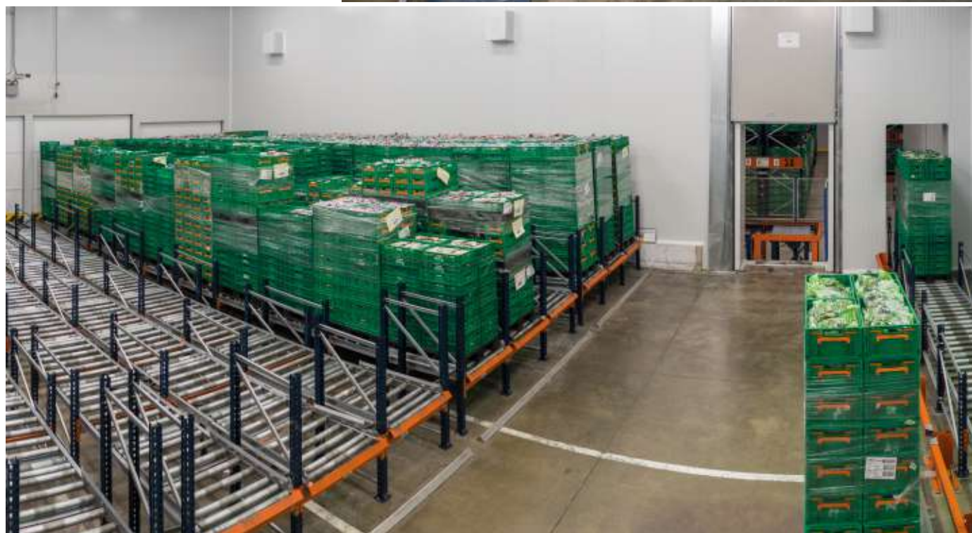
Cuatro de los canales son abatibles para posibilitar las labores de mantenimiento y limpieza
