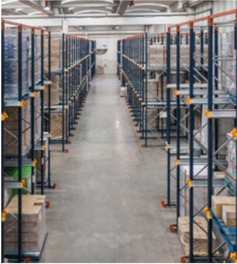
Los operarios, ayudados por máquinas contrapesadas, penetran en el interior de las calles con la carga elevada por encima del nivel en el que va a ser depositada. Estas máquinas destacan por su agilidad a la hora de introducir y retirar la mercancía de sus ubicaciones.
