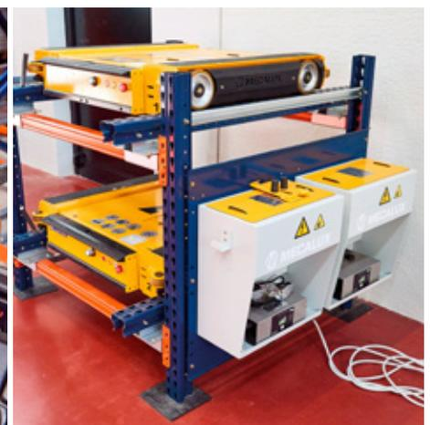
Las baterías se extraen de los carros y se conectan por simple encaje en las estaciones de carga situadas al lado de los muelles.
