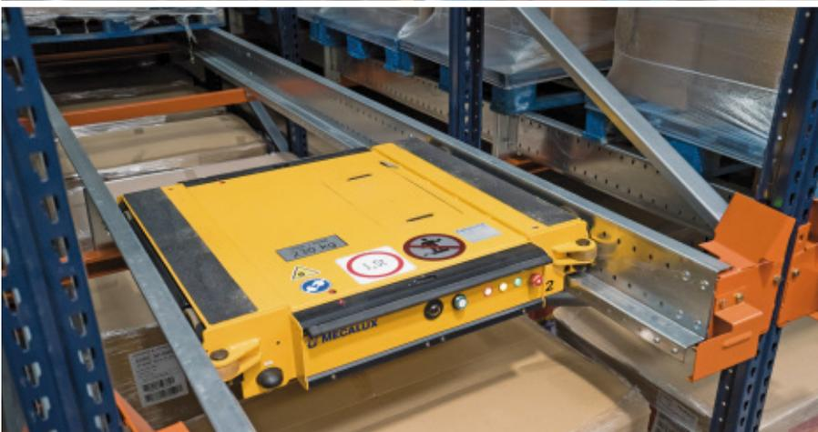
Mecalux ha instalado el sistema Pallet Shuttle en el almacén que Marvimundo posee en Murcia a fin de aumentar la capacidad de almacenaje en 1.000 palets más en la misma superficie y espacio disponibles. De ese modo, la compañía mantiene su compromiso con la innovación y mejora constantes en sus procesos productivos para afrontar el crecimiento alcanzado en los últimos años.
