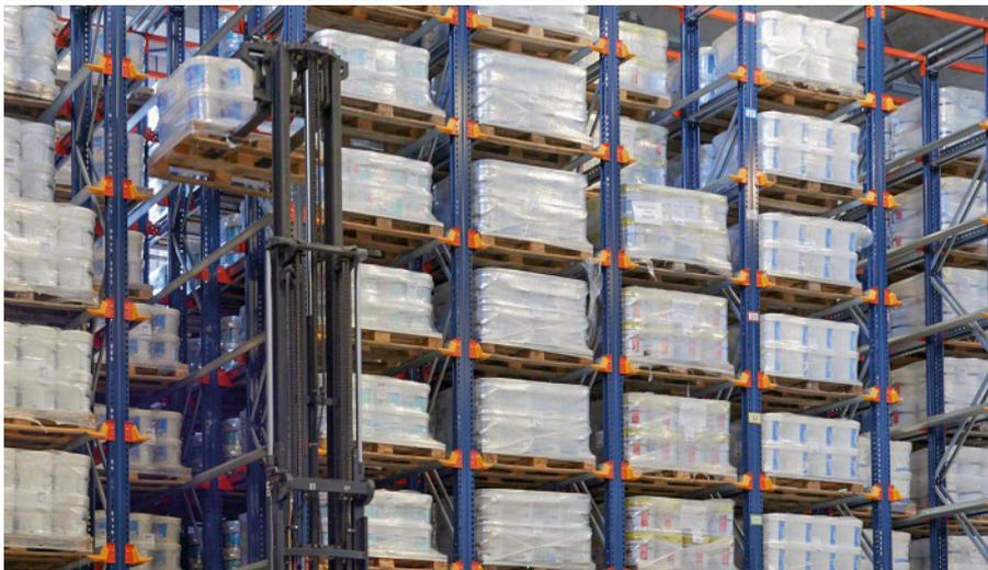
Se han instalado guías en el suelo a ambos lados del pasillo de almacenaje que centran las carretillas y permiten que estas maniobren en el interior con agilidad y seguridad. Ello minimiza los riesgos de impactos para los equipos y las estanterías
