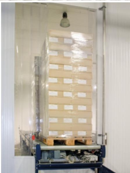
Fabricados en acero inoxidable, los transportadores y equipos auxiliares de esta área son muy resistentes contra la corrosión en zonas húmedas
