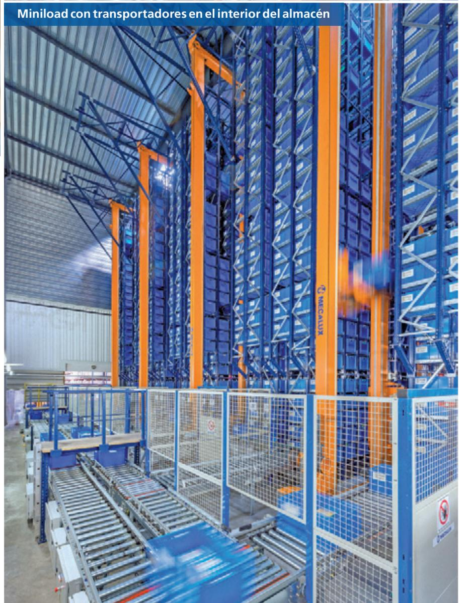
Los transelevadores instalados son de tipo bicolumna, mientras que el sistema de extracción ubicado en la cuna es de doble caja y doble profundidad, siendo capaz de manipular dos cajas a la vez. El extractor está formado por una pala y dos correas con movimiento independiente que permiten coger indistintamente las cajas de uno u otro lado, moviendo la primera hacia el lado contrario al que se va a realizar la segunda extracción.
