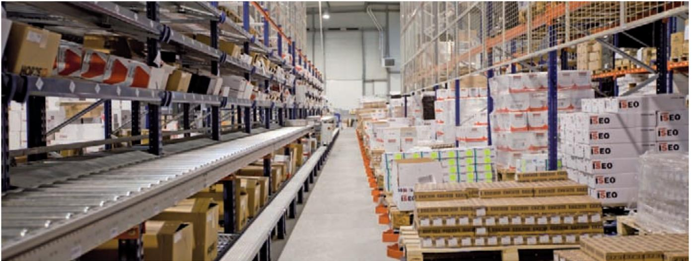
El transportador automático pasa por el interior de las estanterías, entre los niveles 1 y 2. Por la parte exterior y en paralelo a este, se ha instalado un segundo transportador libre que hace la función de mesa de preparación. Cuando los pedidos se han completado, se introducen por empuje en el primer transportador y se desplazan hasta la zona de clasificación/consolidación. Las cajas de cartón que llegan completas de los palets también son introducidas en este transportador.
