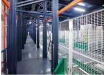
El sistema de gestión de Mecalux, que controla los movimientos de los transelevadores en la instalación, está en comunicación permanente y bidireccional con el ERP y el SGA general de B. Braun, con el fin de lograr un control absoluto del centro logístico
