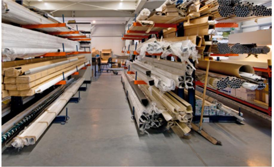
Junto a las estanterías con pasarelas, se han instalado dos estanterías cantilever para las unidades de carga de mayor longitud. Están compuestas por columnas y brazos en voladizo sobre los que reposa la carga. A su lado, se ha habilitado una zona de trabajo donde se cortan los perfiles y se acondicionan algunos de los productos necesarios para los pedidos.
