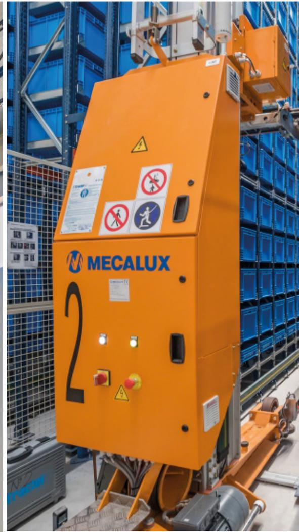
El almacén automático está compuesto por tres pasillos con estanterías de simple profundidad a ambos lados. Las estanterías disponen de 19 niveles, que alcanzan una altura de 8,6 m.
