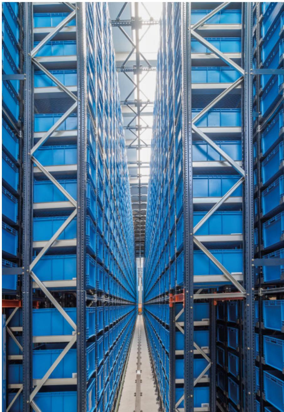
El transelevador está equipado con un sistema de extracción de palas, que se introducen por la parte inferior de las cajas y las extraen o sitúan en las ubicaciones a ambos lados del pasillo.
