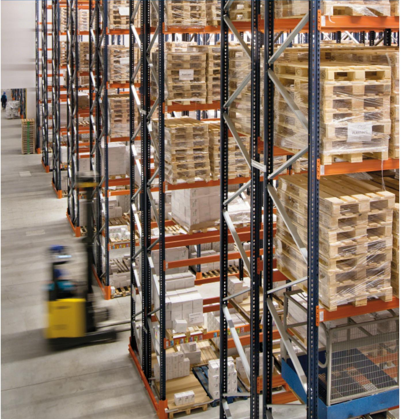
El nuevo almacén de Ziaja, fabricante polaco de cosméticos y productos farmacéuticos naturales, ha sido diseñado específicamente para agilizar la principal operativa de este centro: el picking. Mecalux ha instalado las estanterías de paletización convencional, que ofrecen acceso directo a la mercancía y tienen una capacidad de almacenaje para 10.906 palets.
