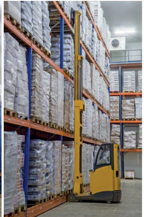
El centro logístico de Bajofrío, capaz de almacenar 6.000 palets, se ha dividido en dos cámaras frigoríficas iguales de 1.000 m<sup>2</sup>, que se mantienen a una temperatura de -25 °C
