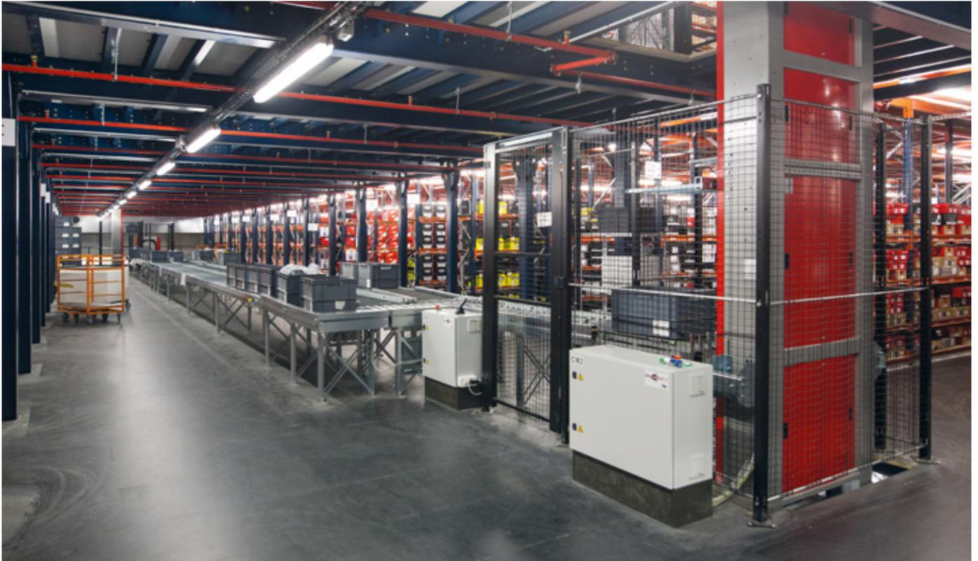
El elevador vertical de cajas se encarga de trasladar de forma automática las cajas hasta el nivel correspondiente
